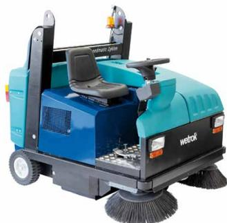
Spazzatrici compatte con uomo a bordo per la pulizia di tutte le superfici nelle aree interne ed esterne. Il modello P-XT con potente motore a benzina è in grado di affrontare agevolmente pendenze ripide o spazi ristretti. Grazie al funzionamento a batteria che evita la produzione di emissioni e riduce il livello del rumore, il modello B è particolarmente indicato per il lavoro nelle aree interne. Filtro in poliestere per lo sporco umido disponibile.
